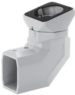
Der Drehbereich beträgt 300 Grad. Das wartungsfreie Lager besteht aus Stahl und Polyamid. Die Kupplung beinhaltet eine Zugangsplatte für eine einfache Verkabelung. Das Gehäuse wird in einem Winkel von 15 Grad montiert. Die Kupplung besteht aus Aluminiumdruckguss und ist mit einem lichtgrauen (RAL 7035) Lack aus Polyesterpulver lackiert. Befestigungselemente, Halterungen und Dichtungen sind inbegriffen.
