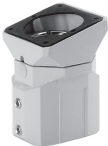
Die Kupplung kann um 300 Grad gedreht werden. Das wartungsfreie Lager besteht aus Stahl und Polyamid. Das Gehäuse wird in einem Winkel von 15 Grad montiert. Die Kupplung besteht aus Aluminiumdruckguss und ist mit einem lichtgrauen (RAL 7035) Lack aus Polyesterpulver lackiert. Befestigungselemente, Halterungen und Dichtungen sind inbegriffen.
