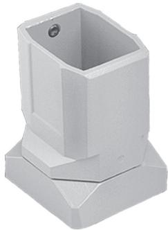
Die Kupplung kann um 300 Grad gedreht werden. Das wartungsfreie Lager besteht aus Stahl und Polyamid. Die Kupplung besteht aus Aluminiumdruckguss und ist mit einem lichtgrauen (RAL 7035) Lack aus Polyesterpulver lackiert. Befestigungselemente, Halterungen und Dichtung sind inbegriffen.
