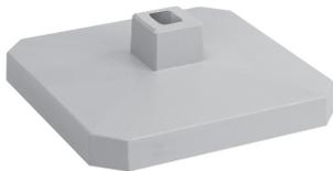
Der Sockel besteht aus einer einteiligen Aluminiumdruckguss-Konstruktion und ist mit einem lichtgrauen Strukturlack (RAL 7035) aus Polyesterpulver lackiert. Alle Teile zur Befestigung von Verbindungsprofilen sind inbegriffen.
