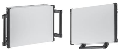
Montieren Sie die Griffe auf den integrierten Griffprofilstücken oder an der Unterseite des Gehäuses. Der Griff ist 340,4 mm lang und kann für kleinere Gehäusegrößen zugeschnitten werden. Das Aluminiumrohr ist mit einem schwarzen (RAL 9005) Lack aus Polyesterpulver lackiert. Die Kunststoffenden sind schwarz (RAL 9005). Der Satz beinhaltet ein Paar Griffe und alle Befestigungselemente.
