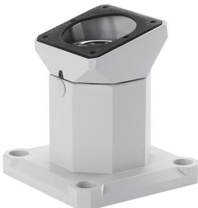
Der Drehbereich beträgt 300 Grad. Das Gehäuse wird in einem Winkel von 15 Grad montiert. Die Kupplung besteht aus Aluminiumdruckguss und ist mit einem lichtgrauen (RAL 7035) Lack aus Polyesterpulver lackiert. Anschlagschrauben und Dichtungen sind inbegriffen. Befestigungselemente sind nicht inbegriffen.
