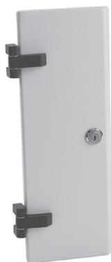
Die Laufwerksklappe kann nur an Gehäusen für den Zugang zu den internen Laufwerken verwendet werden. Schloss ist inbegriffen. Eine Montagevorlage liegt der Montageanleitung bei. Alle Befestigungselemente sind inbegriffen. Die Oberfläche ist mit einem lichtgrauen (RAL 7035) Lack aus Polyesterpulver lackiert. Die Scharniere sind mit einem schwarzen (RAL 9005) Lack aus Polyesterpulver lackiert. Entspricht NEMA Typ 12. Verwendung für 120 mm tiefe Gehäuse nicht möglich.
