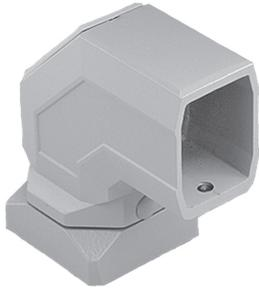
Der Drehbereich beträgt 300 Grad. Das wartungsfreie Lager besteht aus Stahl und Polyamid. Die Kupplung beinhaltet eine Zugangsplatte für eine einfache Verkabelung. Sie besteht aus Aluminiumdruckguss und ist mit einem lichtgrauen (RAL 7035) Lack aus Polyesterpulver lackiert. Befestigungselemente, Halterungen und Dichtung sind inbegriffen.
