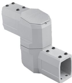
Das Gelenk besteht aus Aluminiumdruckguss und ist mit einem lichtgrauen (RAL 7035) Lack aus Polyesterpulver lackiert. Der Drehbereich beträgt 360 Grad mit Arretierung. Das Gelenk beinhaltet Zugangsplatten für eine einfache Verkabelung, Befestigungselemente und eine Dichtung. Verwendung des Zwischengelenks verringert die Tragfähigkeit des Tragarms um 43 Prozent.
