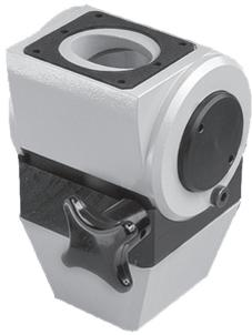
Durch die Befestigung zwischen Tragarm und MMS-Gehäuse kann der Bediener der Maschine sowohl Dreh- als auch Neigeoptionen nutzen. Die Drehfunktion ermöglicht eine maximale Drehung um 300 Grad. Die Neigefunktion ermöglicht die stufenlose Einstellung von horizontal bis 30 Grad. Die Kupplung besteht aus Aluminiumdruckguss und ist mit einem lichtgrauen (RAL 7035) Lack aus Polyesterpulver lackiert. Befestigungselemente, Halterungen und Dichtung sind inbegriffen.
