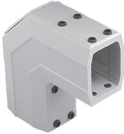
Der Winkel besteht aus Aluminium mit verstärkten Wänden und bietet somit mehr Stabilität und eine größere Tragfähigkeit. Mit Anschlagsschrauben zur Ausrichtung von Verbindungsprofilen. Der Winkel besteht aus Aluminiumdruckguss und ist mit einem lichtgrauen (RAL 7035) Lack aus Polyesterpulver lackiert. Alle Befestigungselemente und eine Dichtung sind inbegriffen.
