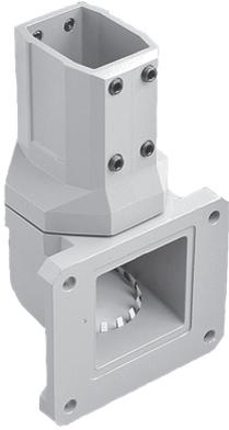
Das vertikale Gelenk beinhaltet eine Zugangsplatte für eine einfache Verkabelung. Der Drehbereich beträgt 300 Grad. Das Gelenk besteht aus Aluminiumdruckguss und ist mit einem lichtgrauen (RAL 7035) Lack aus Polyesterpulver lackiert. Anschlagschrauben, Dichtung und abnehmbare Zugangsplatte sind inbegriffen. Befestigungselemente sind nicht inbegriffen.
