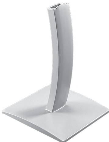
Der Standfuß kann auf dem Boden festgeschraubt oder auf Lenkrollen montiert werden, die als Zubehör lieferbar sind. Das Mittelprofil misst 50,8 x 76,2 mm, wobei der Zugang von hinten zum Verlegen von Kabeln möglich ist. Erfordert Tragarm mit Einzel- oder Doppelneigungsmechanismus für die Gehäusebefestigung. Die Oberfläche ist mit einem lichtgrauen (RAL 7035) Lack aus Polyesterpulver lackiert.
