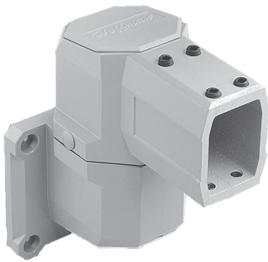
Das Gelenk beinhaltet eine Zugangsplatte für eine einfache Verkabelung. Der Drehbereich beträgt 300 Grad. Das Gelenk besteht aus Aluminiumdruckguss und ist mit einem lichtgrauen (RAL 7035) Lack aus Polyesterpulver lackiert. Anschlagschrauben, Dichtung und abnehmbare Zugangsplatte sind inbegriffen. Befestigungselemente sind nicht inbegriffen.
